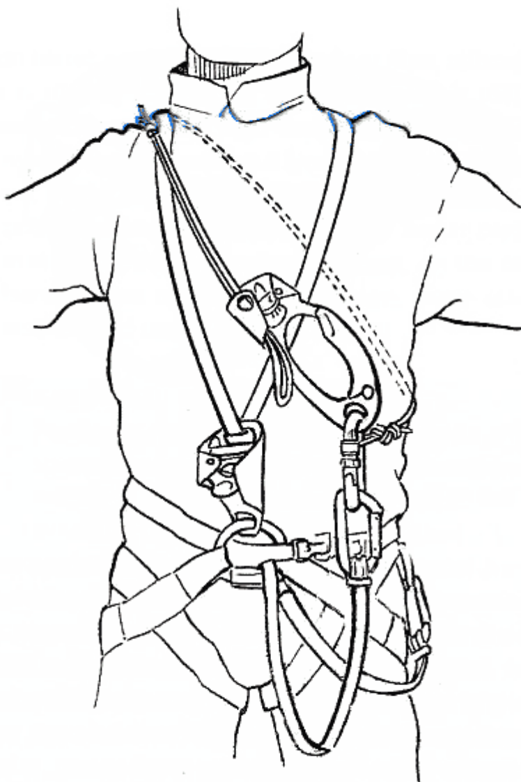
Рис. 31 - Как следует носить снаряжение для подъёма типа "лягушка", передвигаясь между колодцами.
